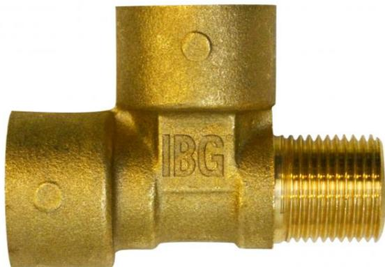
Raccord en T au pas gaz. Ce raccord est idéale pour effectuer différents montage HP. Ce raccord sur la partie mâle est équipé d'un cône de 60° pour l'étanchéité parfaite du flexible HP qui est raccordé.
