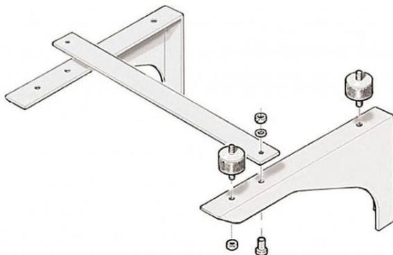
Support équerre pour installation du NHP en poste fixe sur une paroi verticale dans un local.
