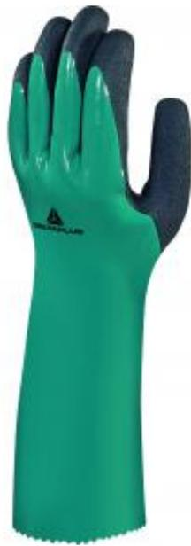
Double enduction nitrile sur support polyamide. Troisième enduction nitrile mousse rugueuse sur paume et bout des doigts. Longueur : 35 cm. Epaisseur: 1,15 mm sur la manchette - 1,30 mm sur la paume.
